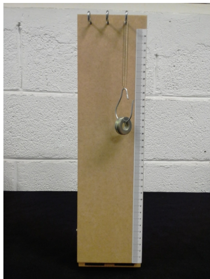
Mola simples sujeita à ação do peso de quatro arruelas
