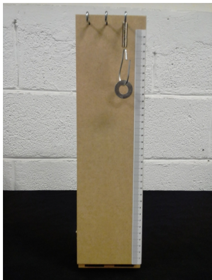
Mola simples sujeita à ação do peso de uma arruela
