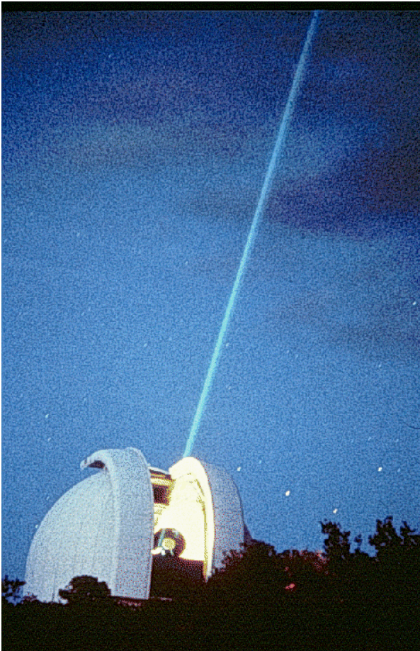
Figura 1. Um raio laser enviado a partir de um observatório é utilizado para medir com precisão a distância da Terra à Lua.
