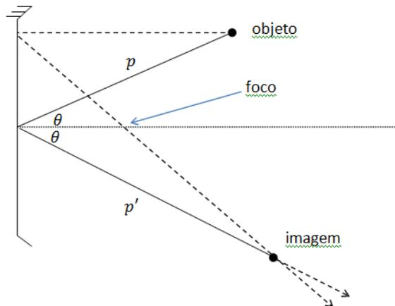
Sendo  $p$  a distancia do objeto ao centro do espelho e  $\theta$  o ângulo com relação ao eixo principal, e este suficientemente pequeno, para que as aproximações do espelho gaussiano continuem validas. Considerando os raios ilustrados na figura acima vemos que se uma imagem bem definida se formar, ela deve estar no plano da figura e seu ângulo com relação ao eixo principal deve ser o mesmo  $\theta$ .
