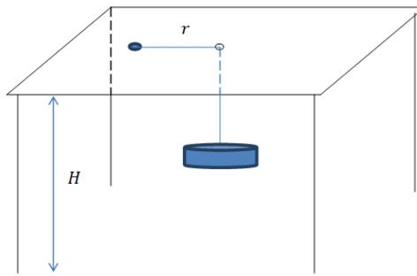
A partícula pode se mover sem atrito pela superfície da mesa (e também não há atritos entre a corda e o orifício). É dada à partícula uma velocidade angular  $\omega$  em torno do orifício (sem nenhuma componente radial de velocidade).
