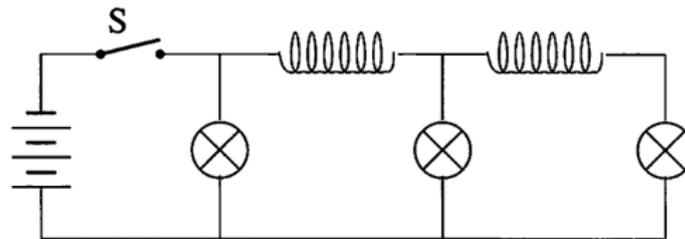
Após algum tempo, a chave  $S$  é aberta. Qual é a razão entre o brilho da lâmpada mais à esquerda com o da lâmpada mais à direita imediatamente após a abertura da chave?
