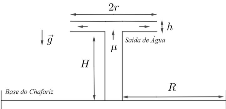
No esquema representado,  $H$  representa a altura do chafariz. A água é liberada radialmente de um disco de altura  $h$  e raio  $r$  e é alimentada à uma vazão constante  $\mu$ . Visando construir um chafariz com as mesmas especificações do enunciado, qual deverá ser o limite inferior para o raio da base  $R$  do objeto visando evitar transbordos? Considere  $H = 40 \text{ cm}$ ,  $h = 2 \text{ cm}$ ,  $r = 5 \text{ cm}$  e  $\mu = 400 \text{ mL/s}$ .
