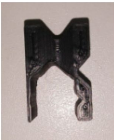
Figura 1: Suporte para posicionamento da caneta de LASER de diodo.
