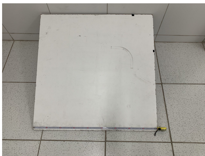
Figura 7: Comprimento da placa quadrada inclinada no apoio sendo medido por uma trena
