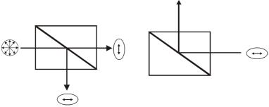
Para um feixe de luz não polarizado que incide no polarizador, a intensidade será igualmente dividida entre as duas componentes de polarização.
