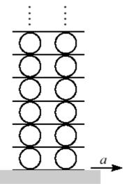
Os cilindros não deslizam com relação às placas de separação, porém a placa de baixo é livre para deslizar sobre a superfície onde está posicionada. Se a placa de baixo é puxada com uma aceleração *a*, qual será a aceleração resultante nos dois cilindros que estão em contato com esta placa?
