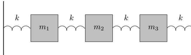
Denote por  $x_1$ ,  $x_2$  e  $x_3$  as posições de cada uma das massas, respectivamente, a partir da posição de equilíbrio do sistema  $(x_1, x_2, x_3) = (0, 0, 0)$  na qual as molas encontram-se no seu comprimento natural. Faça o que se pede nos itens a seguir.
