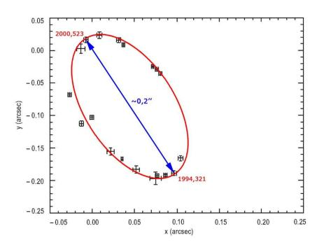
c) Com uma régua podemos estimar o valor do eixo maior da elipse medindo a distância dos pontos extremos e através de uma regra de três simples converter a medida em segundos de arco.
