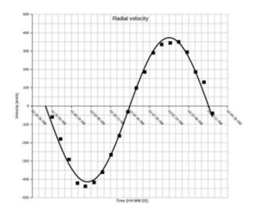
b) Pelo gráfico acima obtém-se a semi amplitude da velocidade orbital:  $v_A$  = 393 km/s. Igualando as forças centrípetas e gravitacionais temos:
