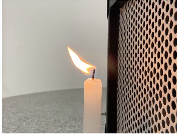
Figura 4: Note que ele somente a curva, embora as condições sejam propícias para a extinção. Assim, foi necessária uma adaptação do aparato.
