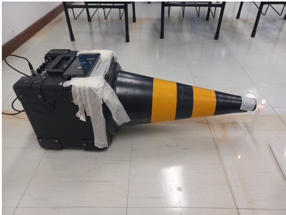
Figura 5: Aparelho completo com a adição do colimador.
