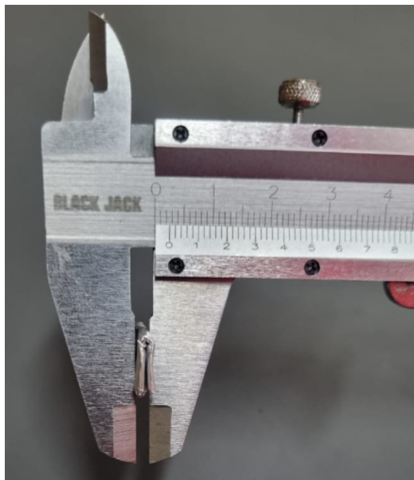
Figura 5.1: Medida da espessura de uma folha de alumínio dobrada 6 vezes
